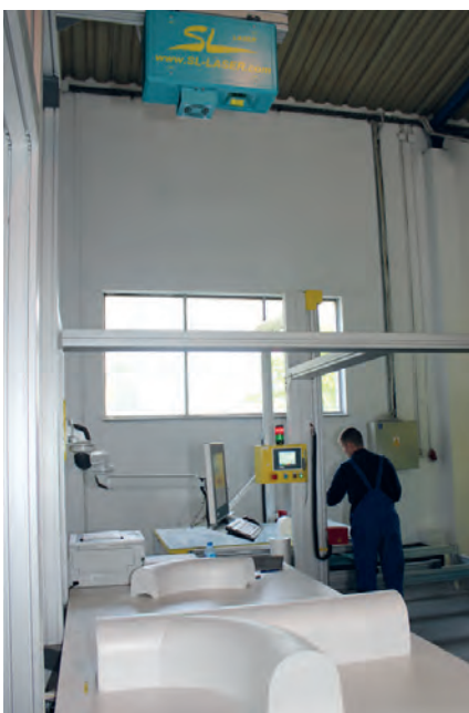
За контроль позиционирования отдельных элементов отвечает лазер, расположенный над рабочим столом и четко проецирующий все контуры изделия на рабочую поверхность
