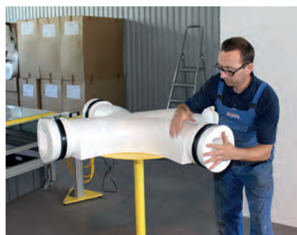
Установка вкладышей приточных патрубков с интегрированным уплотнением
