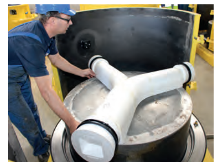
Укладка готового негатива лотка в стальную форму
