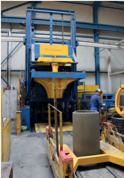
С 2005 г. на заводе Matbet эксплуатируется установка Magic фирмы Schlüsselbauer Technology
